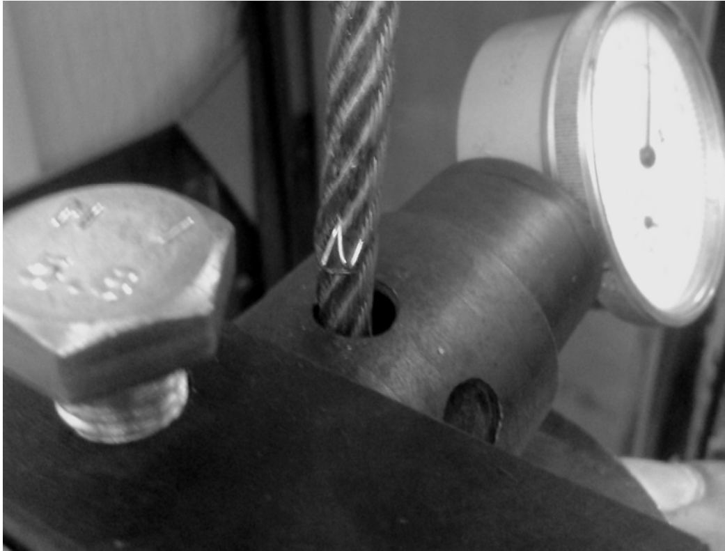
Рис. 10. Руйнування дротин зовнішнього шару каната затискними елементами
