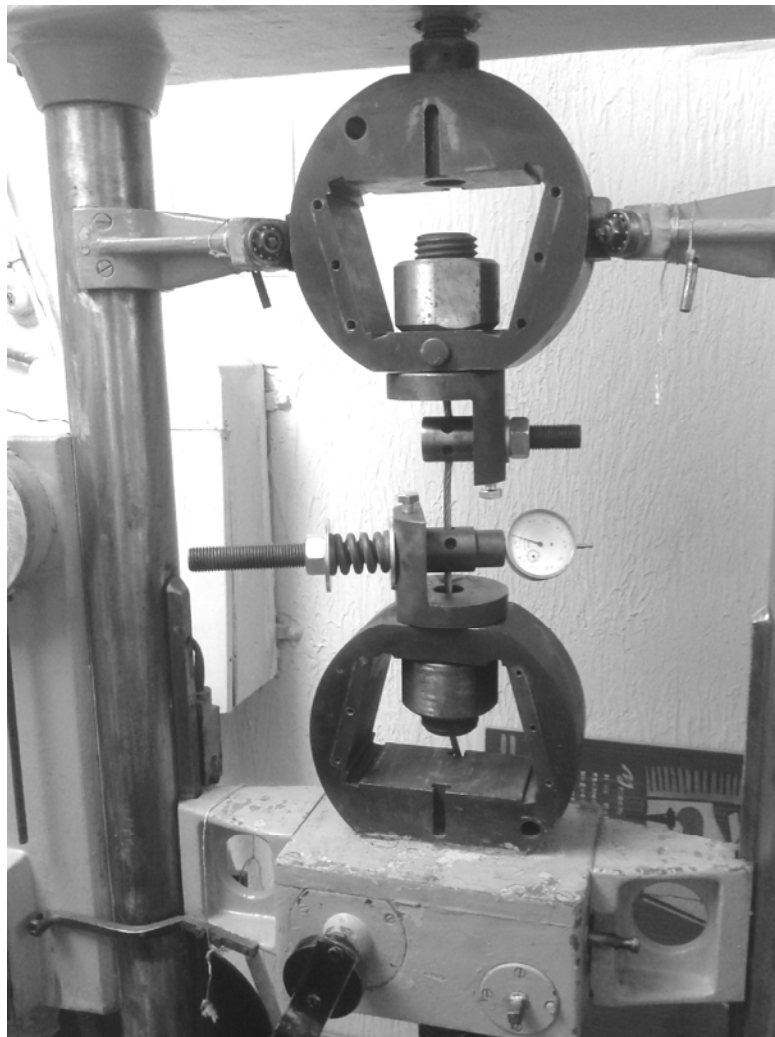
Рис. 4. Дослідження зусилля закріплення каната на розривній машині УММ-5
