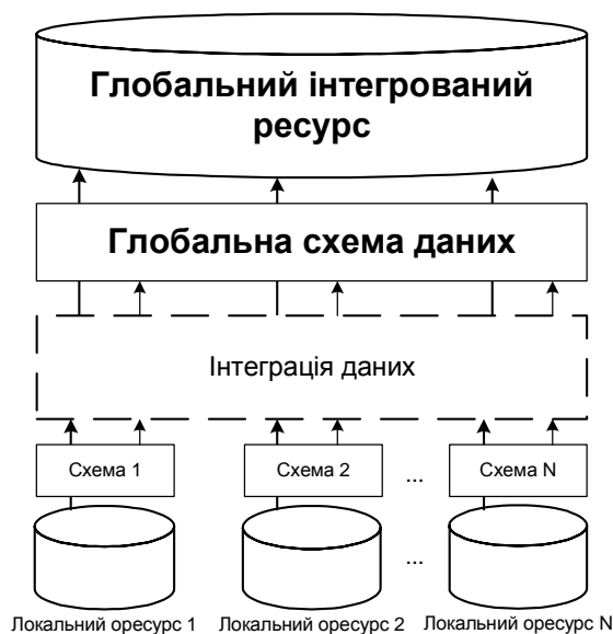
Рис.2. Схема процесу інтеграції даних за розширеною моделлю
