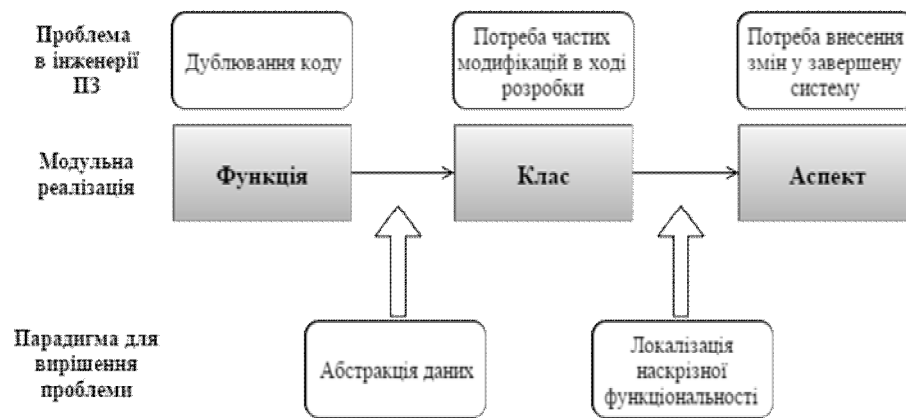
Рис. 1. Значення модуля в інженерії ПЗ
