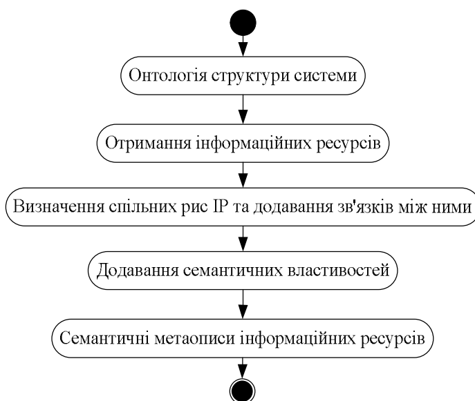
Рис. 5. Схема алгоритму отримання інформаційних ресурсів із системи, що інтегрується
