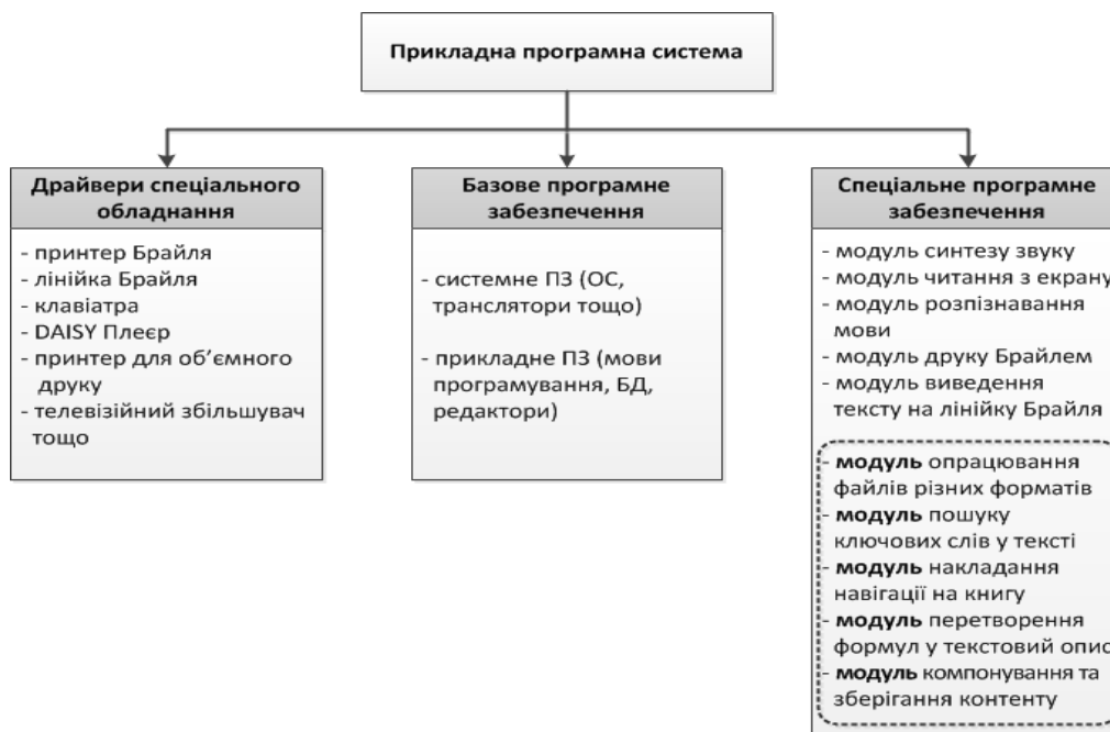
Рис. 10. Структурна схема прикладної системи опрацювання україномовних технічних текстів для людей з вадами зору
