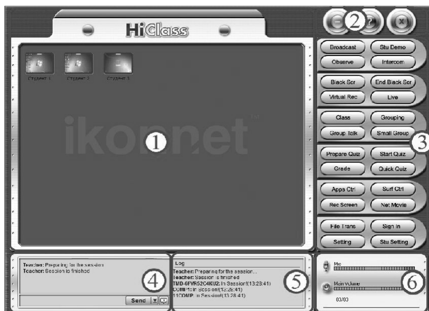
Рис.4. Система управління комп'ютерним класом HI Class: 1 – робоча зона; 2 – елементи керування вікном; 3 – панель інструментів; 4 – вікно чата; 5 – вікно журналу подій; 6 – налаштування звуку
