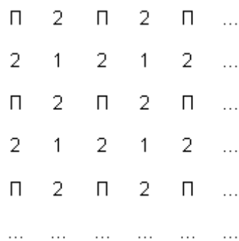
Рис. 3. Схема прогресуючого ієрархічного опрацювання пікселів зображення на шарах, починаючи з другого: П – пікселі попереднього шару; 1 – пікселі першого проходу чергового шару; 2 – пікселі другого проходу чергового шару
