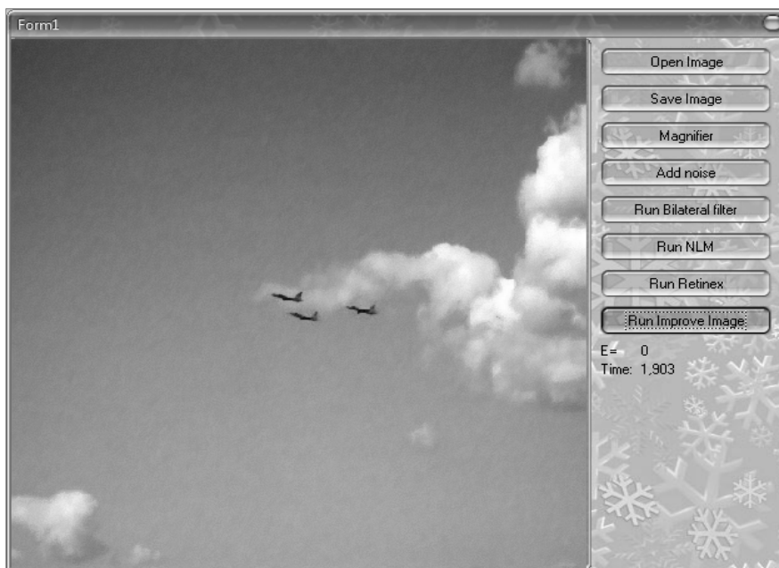
Рис. 4. Приклад зображення кількох літаків на фоні хмар: а – зашумлене зображення; б – опрацьоване зображення
