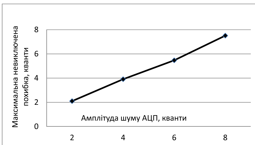
Рис. 6. Залежність максимального значення невиключеної похибки від амплітуди шуму АЦП
