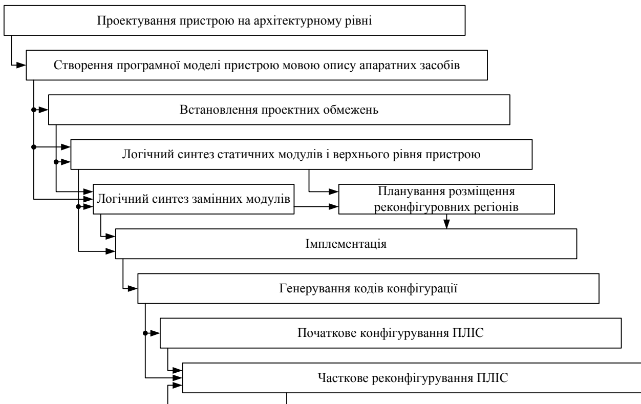
Рис. 5. Методологія проектування комп'ютерних пристроїв із замінними модулями для частково реконфігурованих ПЛІС
