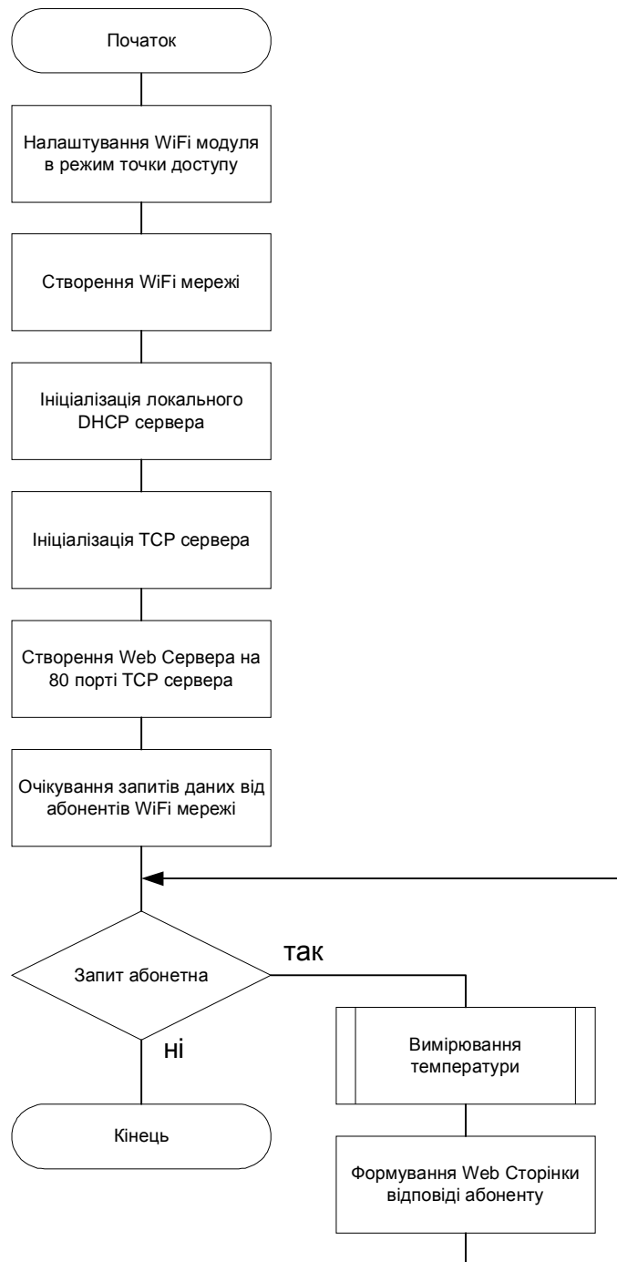
Рис. 10. Алгоритм роботи ТКПС на основі WiFi-модуля та датчика температури
