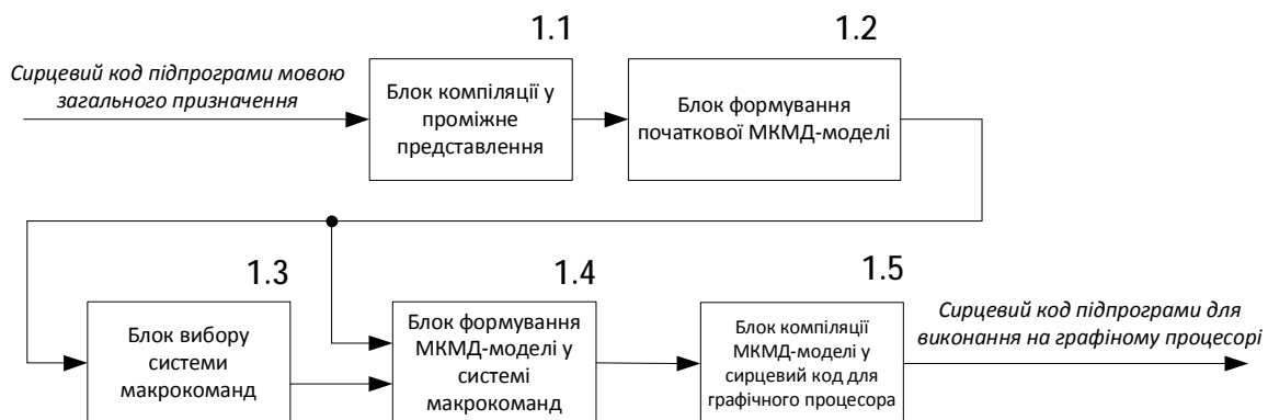
Рис. 2. Блок формування сирцевого коду для графічного процесора
