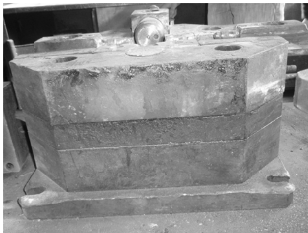
Рис. 4. Форма для лиття водолічильника крильчастого KB-1.5, яка використовується на ПАТ “Електротермометрія” (м. Луцьк, Україна)
