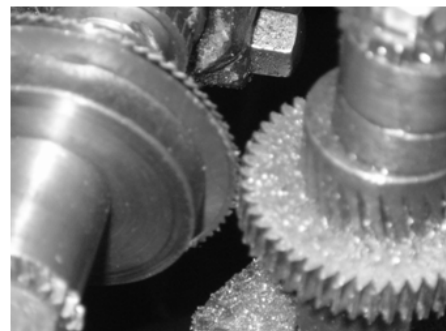
Рис. 11. Нарізання зубчастого колеса дисковою фрезою в умовах неперервного обточування на зубофрезерному верстаті мод. 5E32
