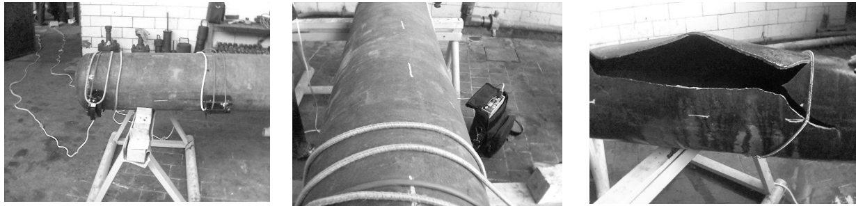
Рис. 3. Руйнівні випробовування внутрішнім тиском труби (діаметр 300мм, товщина стінки 8 мм, матеріал сталь 17Г1С): а – приладна база коерцитиметри КРМ-Ц-К2М; б – деформування труби при виході за зону пропорційних напружень; в – руйнування при досягненні межі міцності та вичерпання запасу пластичності матеріалу
