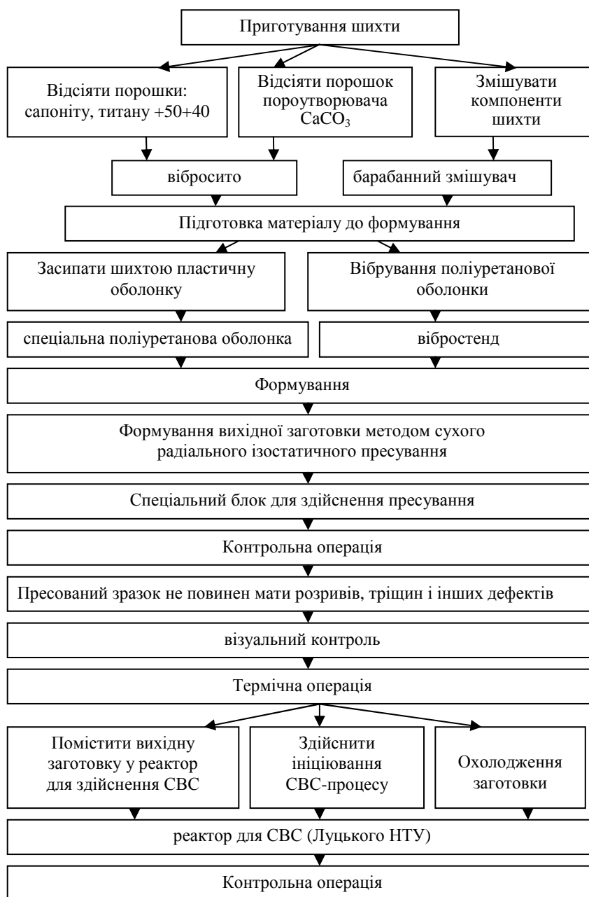
Рис. 2. Технологічна схема методу СВС Луцького НТУ
