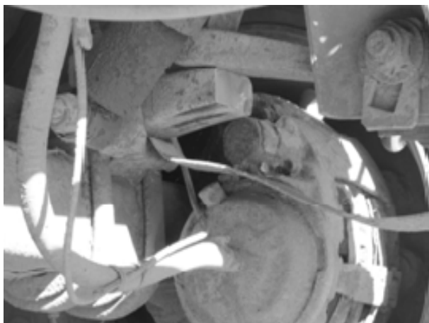
Рис. 2. Світлина несправної підвіски автопоїзда Volvo FH12
