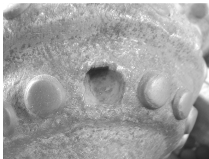
Рис. 3. Випадання зубка із шарошки, виготовленої зі сталі 20ХНЗА, у разі недостатнього натягу при посадці
