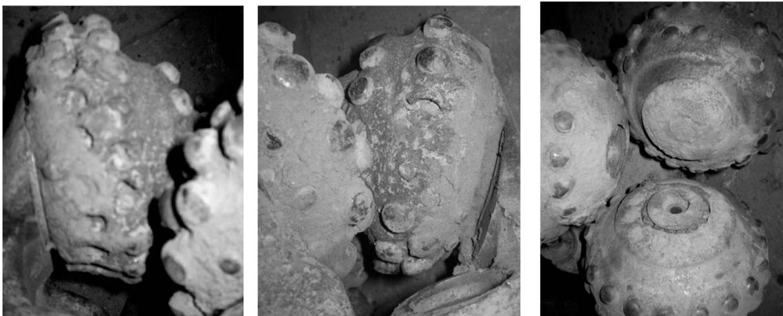
Рис. 3. Характерні руйнування вставного породоруйнівного оснащення доліт
