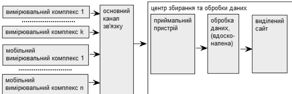
*Rис. 4. Система моніторингу з використанням стаціонарних та мобільних вимірювальних комплексів*
