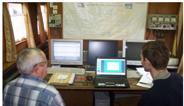
Рис. 2. Запис дефектограми під час роботи вагона-дефектоскопа
