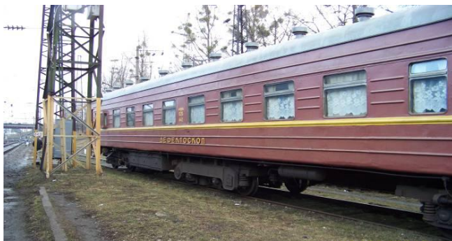
Рис. 1. Загальний вигляд вагона-дефектоскопа Львівської залізниці
