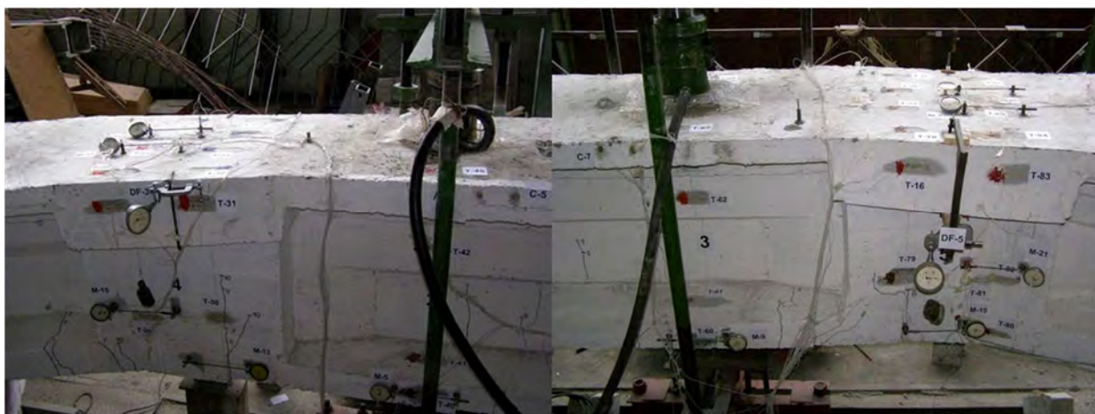
Фото. 2. Загальний вигляд стиків досліджуваної конструкції під час випробувань (лівий і правий відповідно)
