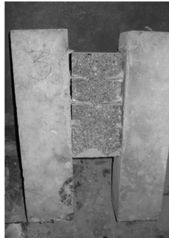
Рис. 1. Дослідний зразок після відривання з бетонної поверхні
