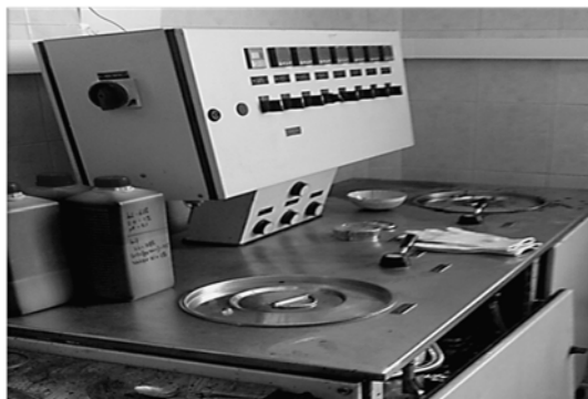
Рис. 1. Лабораторна бітумно-емульсійна установка SEP-0,3R
