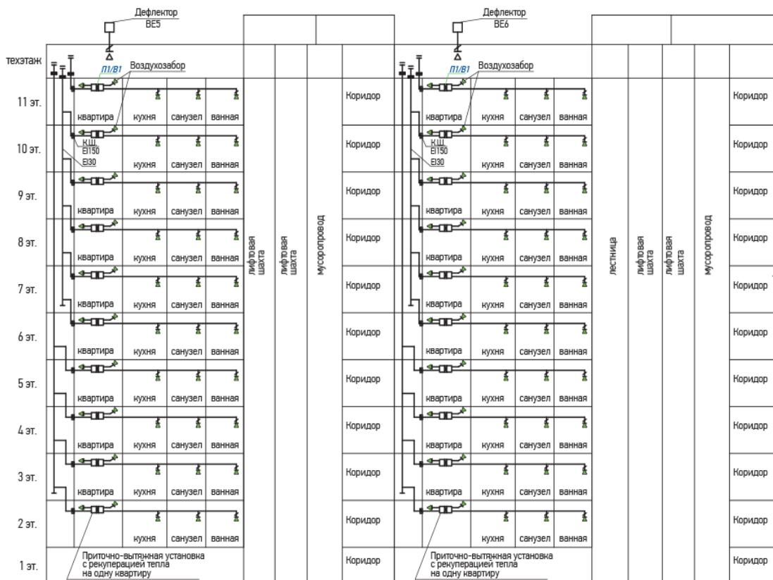
Рис. 2. Принципова схема енергоощадної системи вентиляції житлового будинку [3]
