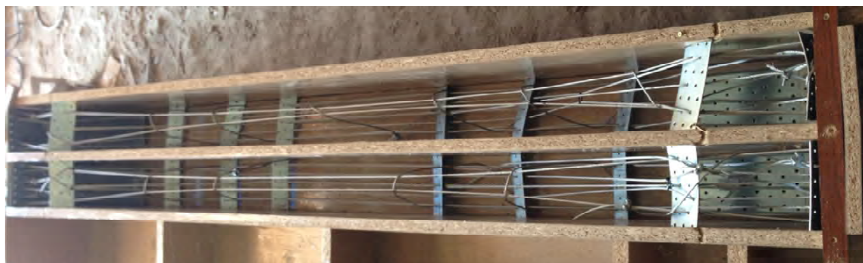
Рис. 1. Загальний вигляд армування зразків-балок
