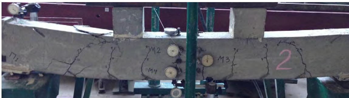
Рис. 6. Тріциноутворення та руйнування балки ФПБ-2
