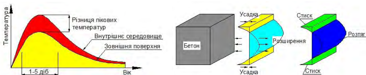
Рис. 2. Схема процесу тріщиноутворення під час гідратації бетону
