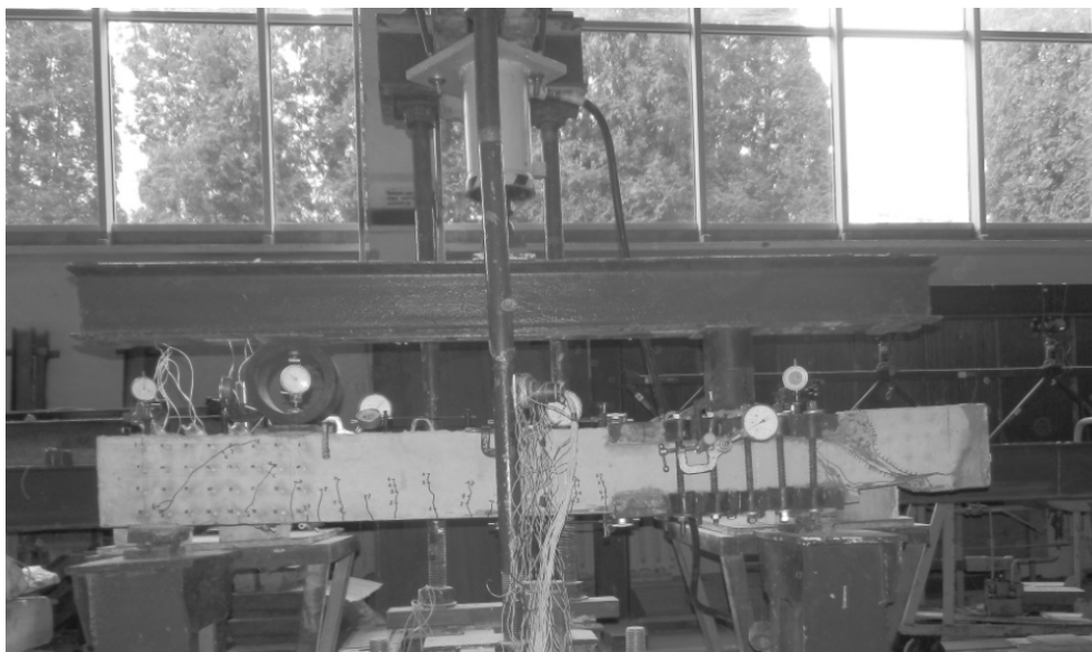
Рис. 6. Схема завантаження другого похилого перерізу балки
