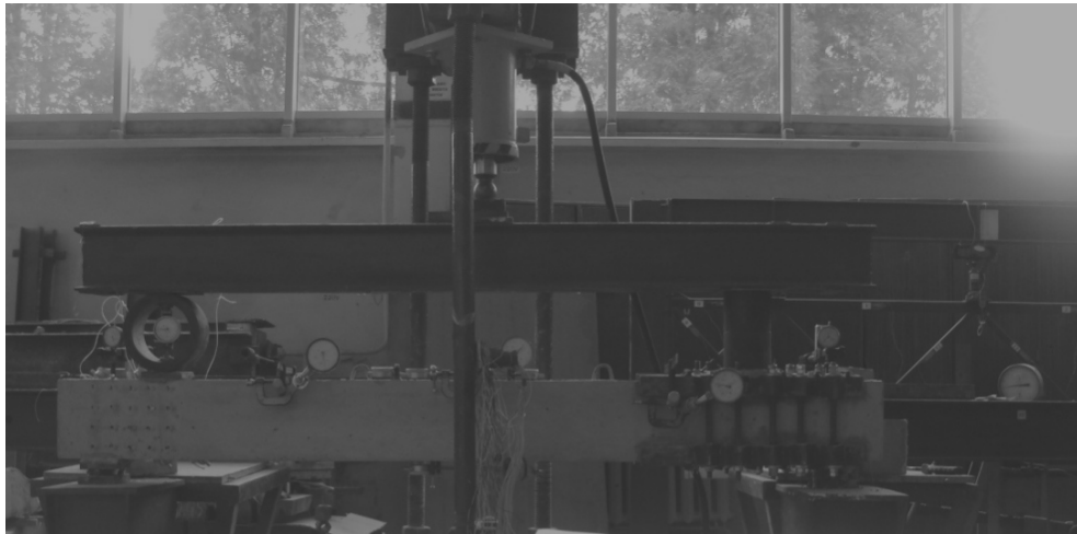
Рис. 5. Схема випробування похилих перерізів залізобетонних балок за вдосконаленою методикою
