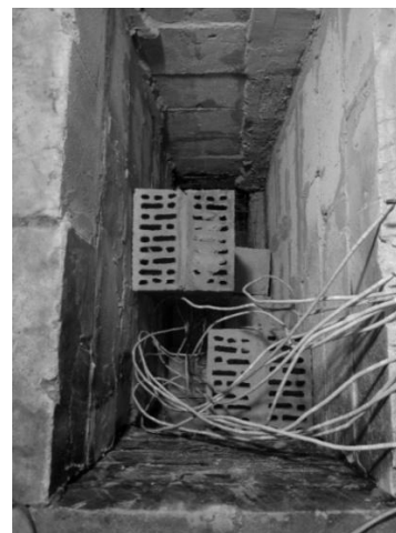
Рис. 4. Схема вогневої печі (вид згори): 1 – пальник; 2 – форсунка; 3, 4 – дослідні зразки; 5 – вентиляційний отвір; 6 – термоприймачі РТ-0102; 7, 8 – термодари
