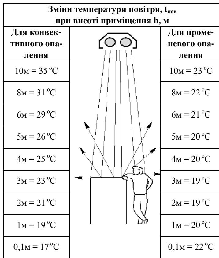
Рис. 1. Температурний градієнт в приміщенні висотою 10 м
