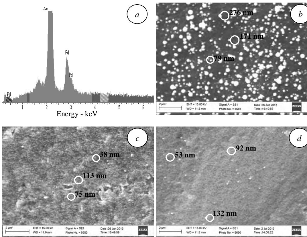
Рис. 1. EDAX наночастинок Pd-Au (a) та SEM-зображення поверхні склографіту з осадом Pd-Au, одержаним у DMSO розчині  $0.004\text{M}$   $\text{PdCl}_2 + 0.004\text{M}$   $\text{HAuCl}_4 + 0.05\text{M}$   $\text{Bu}_4\text{NClO}_4$  за потенціалів (V): b)  $-0.3$ , c)  $-0.5$ , d)  $-1.5$
