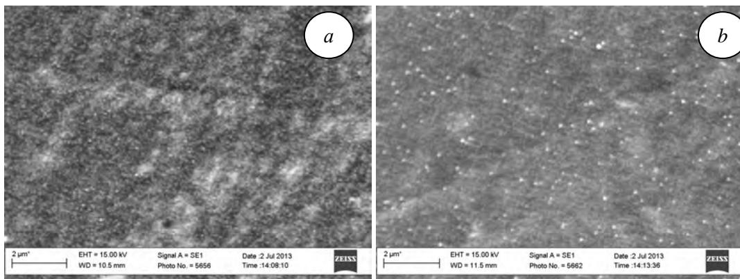
*Рис. 3. SEM-зображення поверхні склографіту з осадом Pd-Au, одержаним у DMSO розчині  $0.004\text{M PdCl}_2 + 0.002\text{M HAuCl}_4 + 0.05\text{M Bu}_4\text{NClO}_4$  за потенціалів (V): a)  $-0.5$ , b)  $-0.75$*
