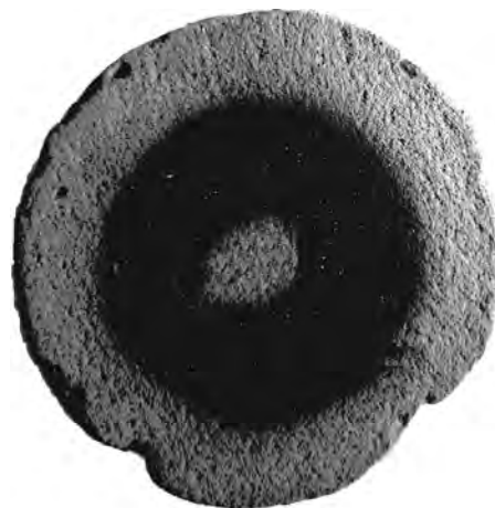
Рис. 7. Структура випаленого взірця, сформованого з відходів збагачення вугілля з добавкою крейди та манганового концентрату
