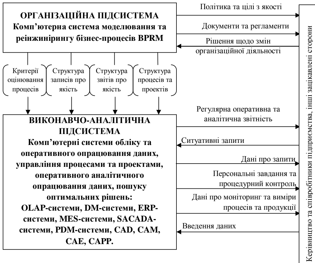
Рис. 3. Структура комп'ютеризованої СУЯ та її інформаційне забезпечення
