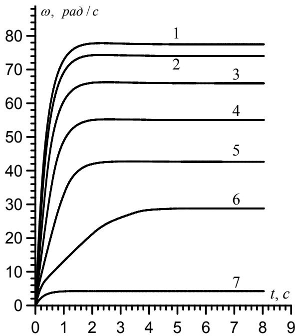
Рис. 2. Криві розгону мотора постійного струму для різних значень кутів запалювання тиристорів: 1 –  $0^\circ$ , 2 –  $20^\circ$ , 3 –  $40^\circ$ , 4 –  $60^\circ$ , 5 –  $80^\circ$ , 6 –  $100^\circ$ , 7 –  $120^\circ$
