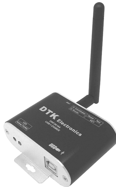
Рис. 2. Приймально-передавальний пристрій ZigBee
