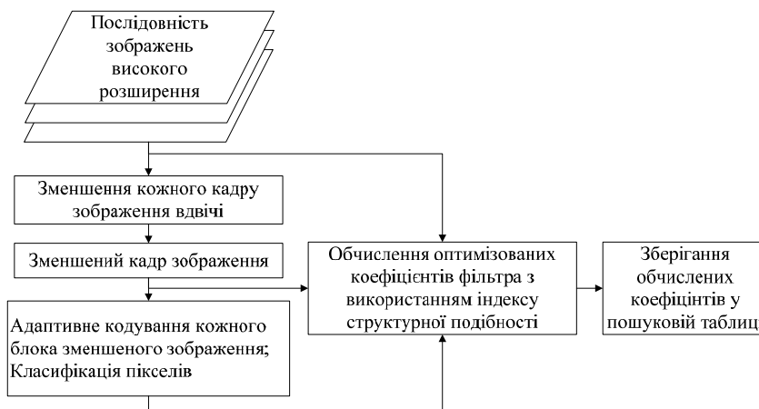
Рис. 3. Схема роботи алгоритму обчислення коефіцієнтів фільтра з використанням індексу структурної подібності
