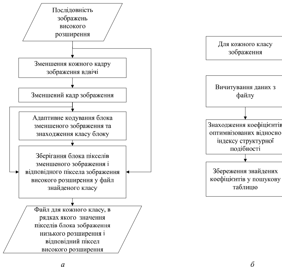
Рис. 4. Блок-схема алгоритму обчислення коефіцієнтів інтерполяційного фільтра: а – перший етап – підготовка тестових наборів даних; б – знаходження коефіцієнтів фільтра для кожного класу
