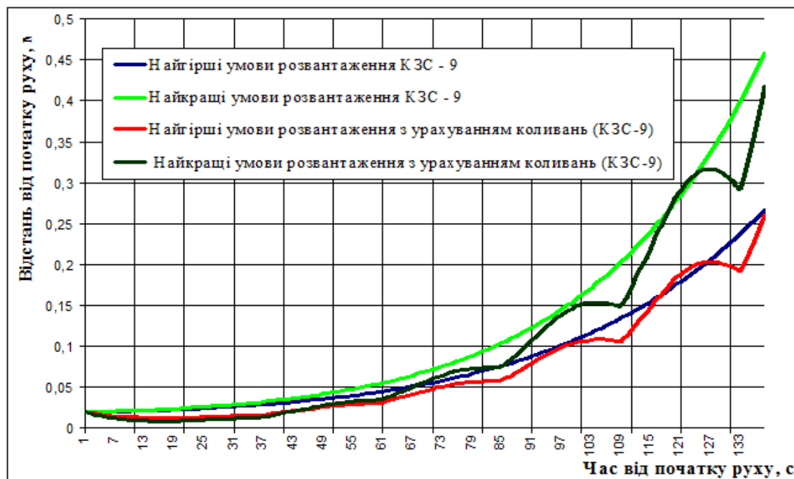
Рис. 3. Діаграма руху порції зерна по скребку елеватора, розрахована на прикладі конструктивних параметрів комбайна КЗС-9 «Славутич»
