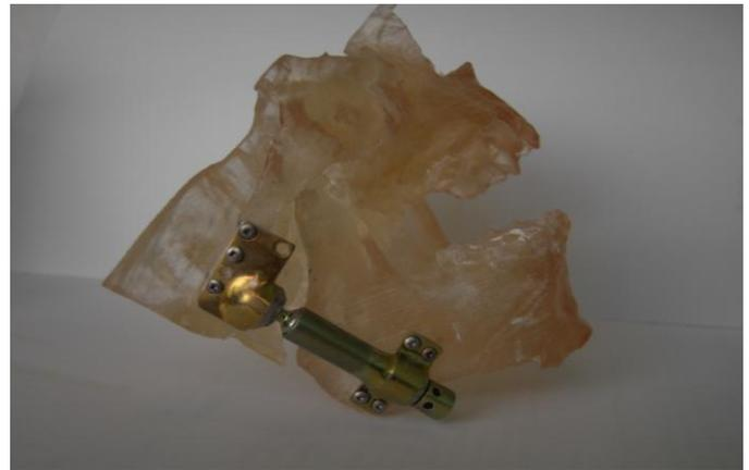
Рис. 2. Полный эндопротез височно-нижнечелюстного сустава с дистракционным устройством, фиксирован на стереолитографической модели.
