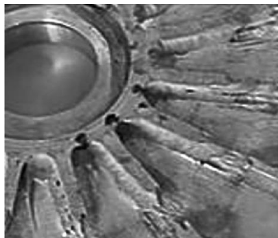
Рис. 2. Приклад кавітаційної корозії нафтогазового обладнання
