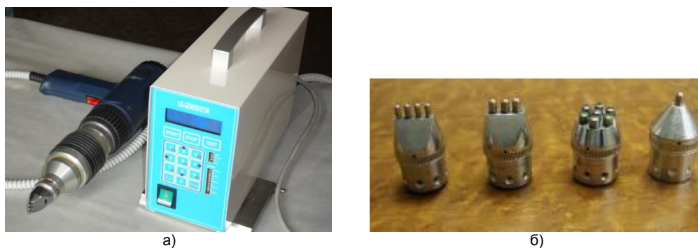
Рис. 2. Оборудование для ВМП стыковых сварных соединений а – общий вид оборудования для ВМП сварных соединений; б – сменные головки с цилиндрическими бойками
