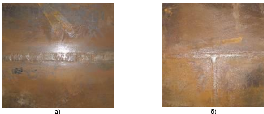
Рис.1. Фотографии образцов стыковых сварных соединений а) – продольным сварным швом; б) – пересекающимися сварными швами
