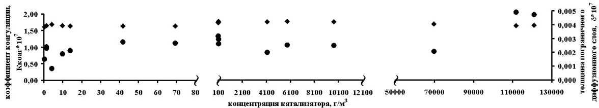
Рис. 6. Влияние концентрации катализатора на процессы коагуляции и толщины пограничного диффузионного слоя (• ( \delta ) - толщина пограничного диффузионного слоя; \blacklozenge ( K_{коаг} ) - коэффициент коагуляции)
