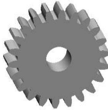
Рис. 4 Модель прямозубого циліндричного колеса на основі OpenGL
