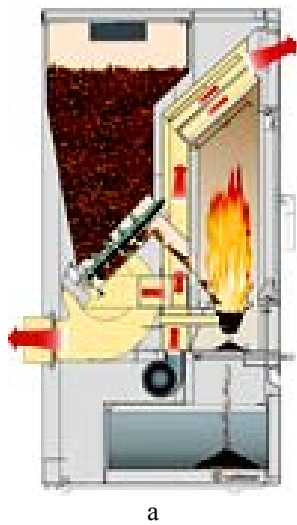
Рис. 5. Котлы со специальными pelletными горелками а - pelletный котел с топочной арматурой; б - pelletный котел с pelletной горелкой
