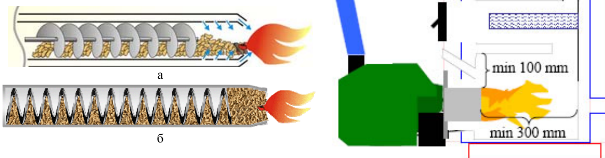
Рис.3 Факельная автоматическая пеллетная горелка: а - с осевым шнеком AqroLine; б - с безосевым шнеком повышенной мощности
