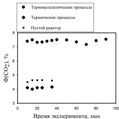
Рис. 2. Результаты тест-экспериментов по окислению уксусной кислоты. Зависимость объемной доли углекислого газа в газовой пробе от времени опыта
