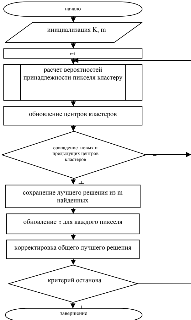
Рис. 1. Блок-схема алгоритма сегментации изображений методом муравьиных колоний
