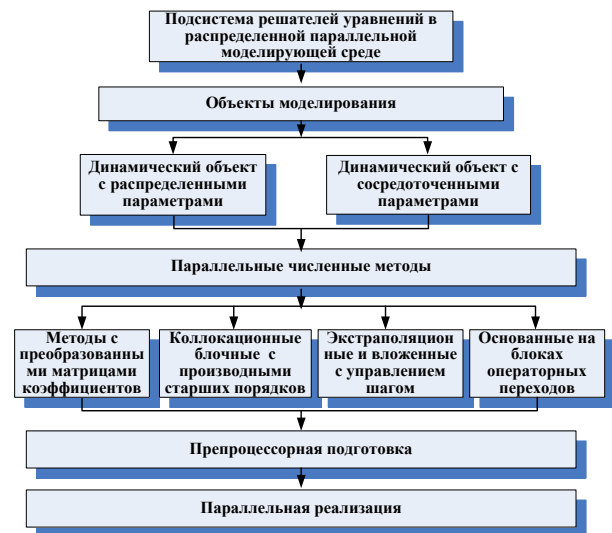
Рис. 2. Структурная схема подсистемы решателей для РПМС
