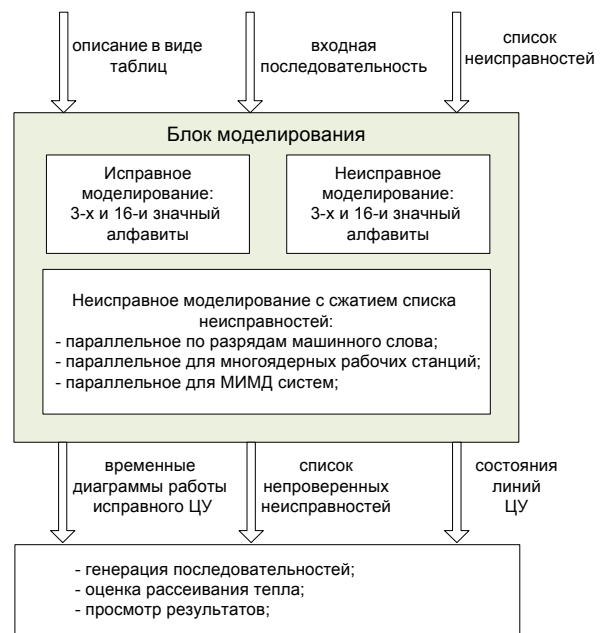
Рис.3. Подсистема моделирования и её входные/выходные потоки данных
