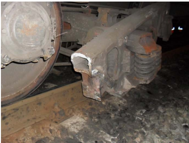
Рис. 1. Типове руйнування бічної рами візка типу 18-100
