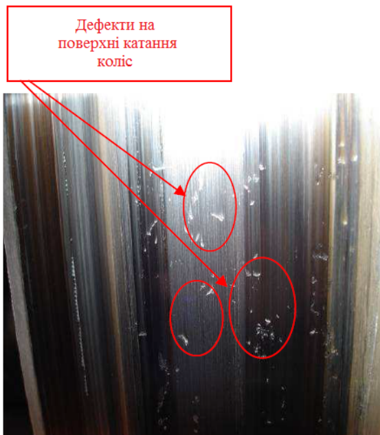
Рис. 1. Дефекти на поверхні катання коліс
