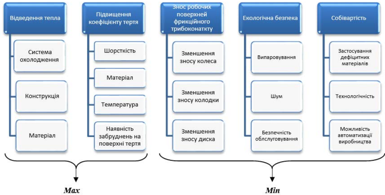
Рис. 5. Схема по отриманню оптимального варіанту конструкції гальмівної колодки для конкретного рухомого складу
