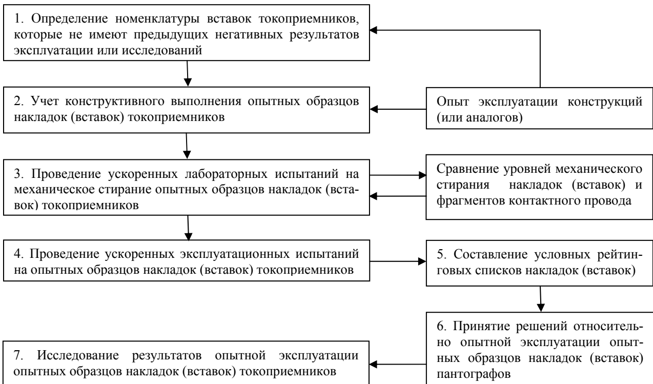
Рис. 1. Методика сравнительной оценки качества накладок токоприемников
